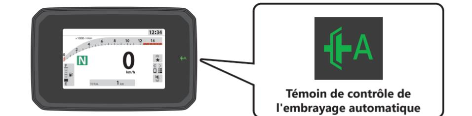
► Lorsque l'embrayage Honda E-Clutch est activé, le jeu du levier d'embrayage est un peu plus important
